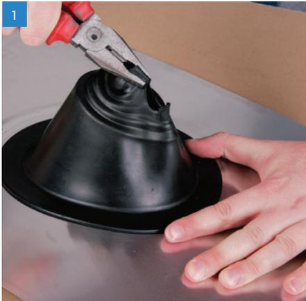
1 Wählen Sie einen geeigneten Master Flash® Residential mit einem Rohrbereich, der über das benötigte Maß hinausgeht. Beachten Sie bei Bedarf die auf dem Master Flash® vorhandenen Abstufungen und ziehen Sie mit einer Zange an der Lasche, um eine Öffnung zu schneiden, die 20-30% kleiner als der Rohrdurchmesser ist.
